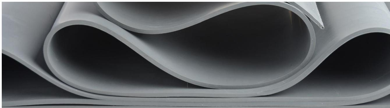
NR 40 Grey – высококачественная, серая мембрана из натурального каучука с гладкой поверхностью твердостью 40 Шор А. Высокая рабочая температура до 130 С и высокое удлинение до 700% позволяют продлить срок службы мембраны. Больше циклов, меньше простоев. Мембрана предназначена для использования в мембранных вакуумных прессах в деревообрабатывающей промышленности. Эластомер NR 40 произведен ЕС.
