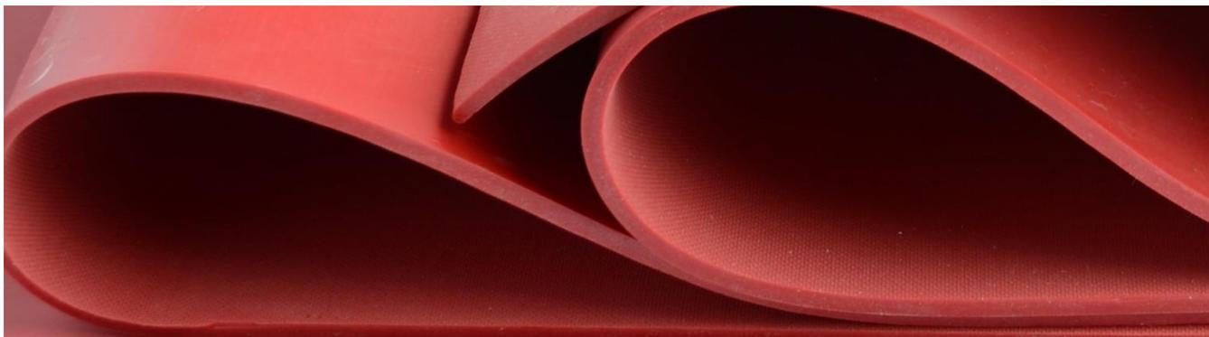
NR 40 Red – высококачественная, красная мембрана из натурального каучука с гладко-текстурной поверхностью твердостью 40 Шор А. Высокая рабочая температура до 130 С и высокое удлинение до 700% позволяют продлить срок службы мембраны. Больше циклов, меньше простоев. Мембрана предназначена для использования в мембранных вакуумных прессах в деревообрабатывающей промышленности. Эластомер NR 40 произведен ЕС.
