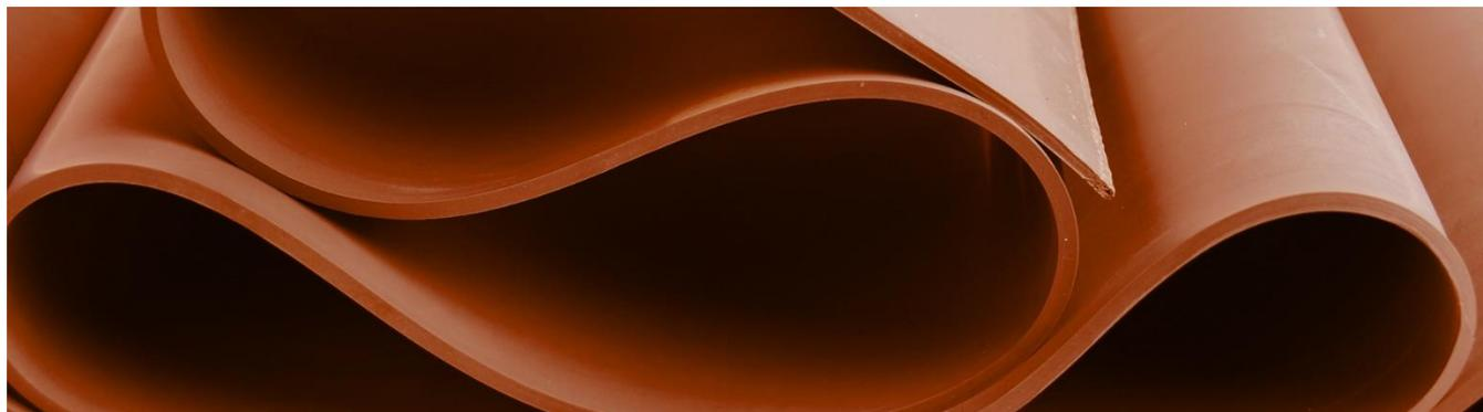
SM 40 Brown - Hochwertige, braun Silikonmembran mit Härte von 40 Shore A. Silikonmembran ist aus Hochleistungskomponenten hergestellt. SM 40 ist die optimale Kombination von Elastizität und Festigkeit. Der Membran hat eine hohe Temperaturbeständigkeit bis 250 ° C und eine Elastizität von 700%, was den Einsatz des Silikonmembran in der Formen ermöglicht. Die Silikonmembran SM 40 ist die beste Entscheidung für Sublimat von Verbundkunststoffen in Vakuumpressen.
